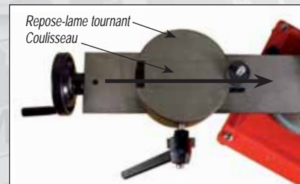
Photo 8 : position du repose-lame tournant (avec le coulisseau dans l'axe du bras support) : puis pousser le coulisseau en direction de la meule.
