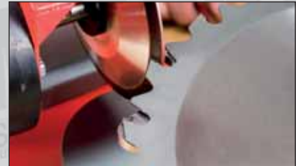
Photo 12 : réglage de l'angle d'attaque frontal : la face de la dent est parfaitement plaquée à plat contre la meule.
