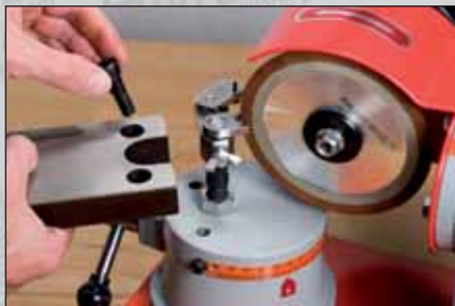
Photo 3 : montage du bras-support.
