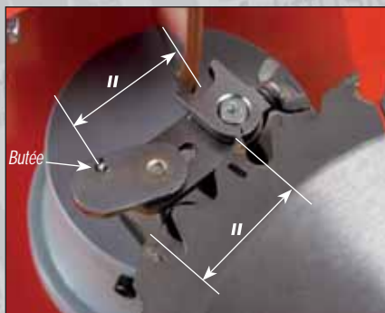
Photo 13 : utilisation de la butée : l'écartement entre la butée et la meule correspond au "pas" de votre lame (c'est-à-dire à l'écartement entre deux dents successives).
