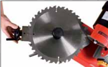
Photo 9 : rapprochez la lame de la meule.
