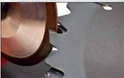
Photo 11 : réglage de l'angle d'attaque : l'arête de la dent est parfaitement alignée contre la meule.
