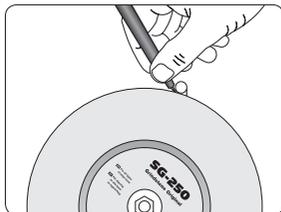
Tracez une ligne en travers de la meule avec le support universel pour guide.
