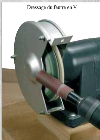
Faites tourner le feutre et poncez sa surface à l'aide du manchon monté sur la perceuse en appuyant légèrement.
