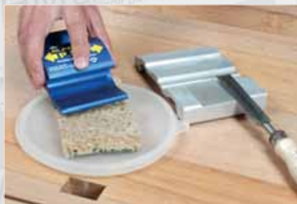
Lubrification de la pierre à l'aide d'une éponge humide.
