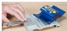
Il ne reste plus qu'à réaliser la même opération avec la pierre blanche de finition puis à démorfiler le biseau, c'est-à-dire à enlever la petite frange de métal qui se forme sur le tranchant : un bref passage de la planche du
