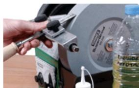
Le liquide d'affûtage est également adapté aux affûtages au touret, il suffit de diluer quelques millilitres de produit dans le bac à eau. Le ToolSave n'altère en aucun cas les meules.
