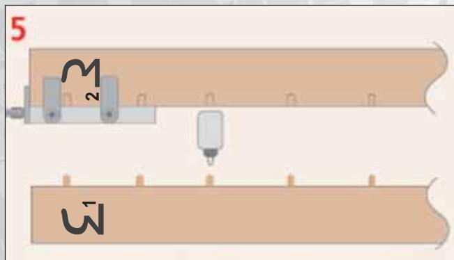
Retourner les butées du gabarit afin d'usiner la seconde pièce de la même manière. Vos pièces sont prêtes pour l'assemblage !
