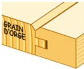
Elles sont destinées à la réalisation des panneaux et lambris de 12 à 19 mm d'épaisseur. Pour le parquet, le grain d'orge sera positionné en sous face.
