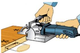
L'assemblage à lamelles, réalisé à l'aide d'une fraiseuse spécifique, est une forme de bouvetage très simple à mettre en oeuvre. En effet, la fraiseuse, grâce à sa conception spécialement étudiée, ne nécessite ni calage, ni gabarit d'usinage (sa table d'appui est généralement réglable en hauteur et inclinable en continu de 0 à 90°).
