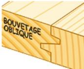
Leur profil symétrique permet un bouvetage par retournement en un seul réglage. La forme oblique du bouvetage facilite la présentation des pièces longues et est autobloquante.
