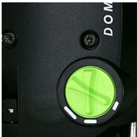
Trois positions qui permettent de faire varier plus ou moins la largeur de la mortaise afin d'offrir un jeu de fonctionnement qui facilitera ensuite le montage des éléments.
