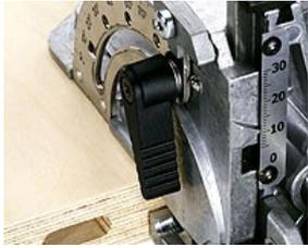
A l'aide de la graduation : réglage manuel aisé et précis à la hauteur souhaité, suivant l'épaisseur de vos bois à fraiser ou pour des assemblages renforcés à double Domino.
