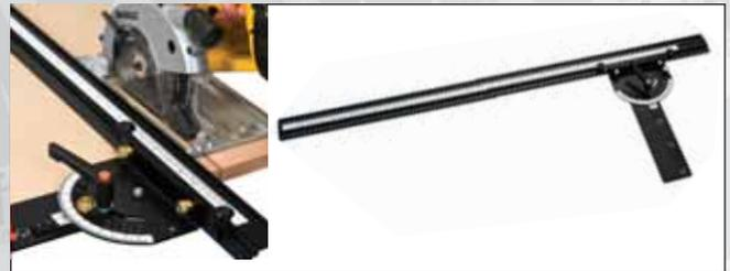
Le système de réglage angulaire est livré avec un rail de 915 mm. Il se fixe sur le rebord de la pièce avec 2 serre-joints et la fixation sera renforcée par un troisième serre-joint en bout de rail.
