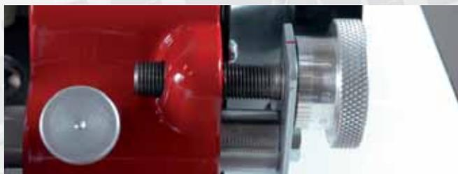
Réglage précis à l'aide des molettes micrométriques.
