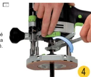
Système de serrage de fraise à cliquet, interverrouillé avec l'interrupteur pour éviter tout démarrage alors que la pince est bloquée : puissance, facilité et sécurité.
