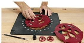
Il est similaire à celui utilisé pour le défonçage ornemental : deux gabarits comprenant différents motifs à inclure se positionnent sur la plaque-support.
