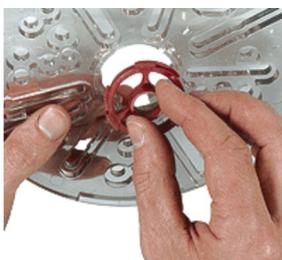
3 - Monter la petite bague de copiage sur votre défonceuse puis découper l'inclusion. Comme pour l'étape précédente : il suffit de se laisser guider ! L'idéal est de choisir deux bois aux teintes contrastées pour réaliser l'incrustation et l'inclusion.
