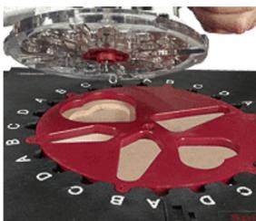
2 - Monter la fraise droite spirale fournie et la grande bague de copiage sur votre défonceuse puis défoncer l'incrustation (c'est à dire l'évidement qui recevra plus tard la pièce à incruster).
