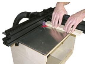
Le plateau de défonceuse en acier est la base du système. Vous installerez dessus le guide parallèle et le guide perpendiculaire pour retrouver les mêmes fonctionnalités que sur une toupie munie d'un chariot de tenonage.
