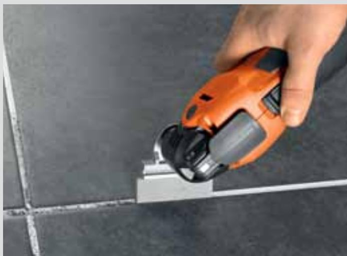
L'outil de nettoyage de joints de carrelage FEIN permet de nettoyer les joints très sales rapidement et facilement sans endommager le carrelage. Les joints même très sales apparaissent comme neufs. Avec sa longue durée de vie, il représente une alternative particulièrement économique à un rejointoiement complet. Idéal pour les piscines, les établissements hôteliers, ainsi que les salles de bain et cuisines dans les logements particuliers.
