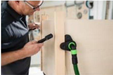
Maintien d'un martyr de serrage lors d'un collage de caisson
