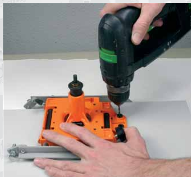
Photo 11 : perçage de la porte Photo 12 : perçage du montant
