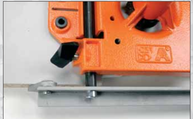
Photo 5 : butée pivotante en appui contre le montant
