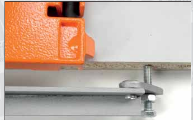
Photo 6 : butée pivotante en appui contre la porte
