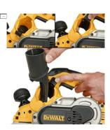
L'aspiration des copeaux à proprement parler sera ensuite confiée soit à un aspirateur électroportatif, soit effectuée à l'aide du sac collecteur de copeau livré d'origine.
