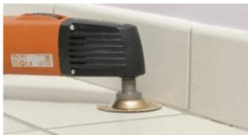
**Segment plat** : contrairement à la lame circulaire, il permet de s'approcher au plus près d'une cloison ou d'un angle.
