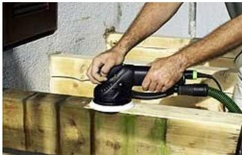
La Rotex RO150 délivre une puissance de 720 watts et son amplitude d'oscillation du plateau est de 5 mm. C'est la machine des hauts rendements.
