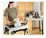
Sur cette table de base les différents modules sont interchangeables : modules de sciage, de défonçage et de chantournage, transformant vos outils électroportatifs Festool en machines stationnaires.
