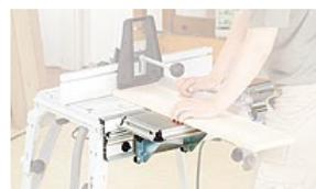
En fraisage à la défonceuse, la table coulissante est idéale pour tenonner ou contre-profiler. Elle nécessite aussi l'acquisition de la butée angulaire WA ci-dessous (car non livrée avec les modules de défonçage).
