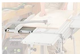
Il élargit la table de base pour des sciages sûrs et précis sur de grandes largeurs. Il est muni d'une échelle graduée.
