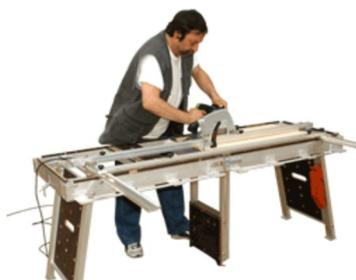
C'est l'option indispensable, il permet de réaliser des travaux guidés de coupe à la scie circulaire (ou de fraisage à la défonceuse).
