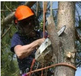
La tronçonneuse élagueuse a la particularité de ne posséder qu'une seule poignée sur le dessus de la machine. Cette poignée permet à la fois le maintien et la commande des gaz. La machine, qui fait l'objet d'une recherche poussée afin d'être compacte et légère, peut donc être manoeuvrée d'une seule main mais reste très délicate à maîtriser parfaitement.
