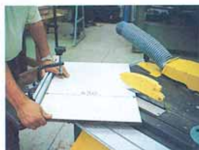
Tests de la capacité de coupe en avant de la lame pour un angle de 45°.
