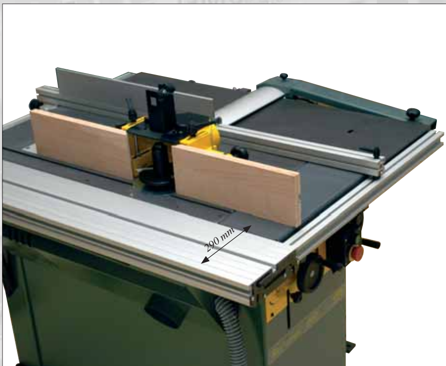
Vue n° 5 : le guide est placé parallèlement au chariot coulissant
