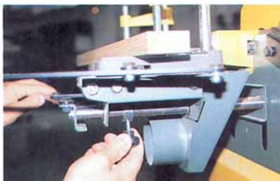
Réglage de la butée déterminant la profondeur de la mortaise.
