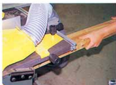
Le rabotage à plat, le capteur au dessus sert de protection.
