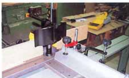
Mise en place de la tablette de tenonnage.
