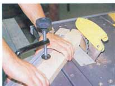
Double inclinaison de la lame pour des arêtiers.
