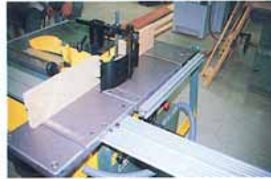
Mise en place du guide.
