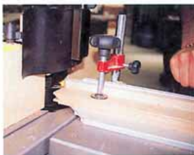
Tenonnage perpendiculaire en cours pour une pièce d'un meuble.
