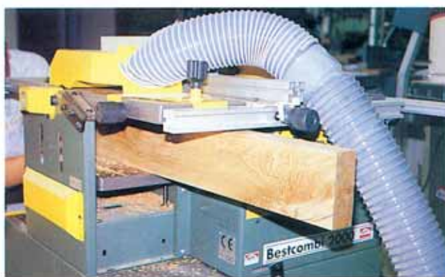
Le rabotage sur chant est possible pour les pièces jusqu'à 200 mm de hauteur.
