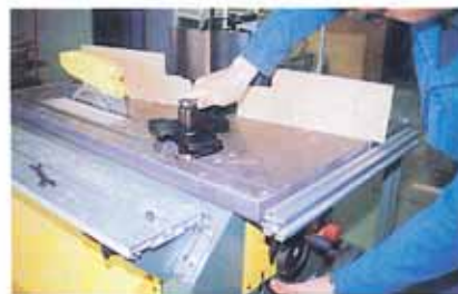
Montage de l'outil et blocage de l'arbre
