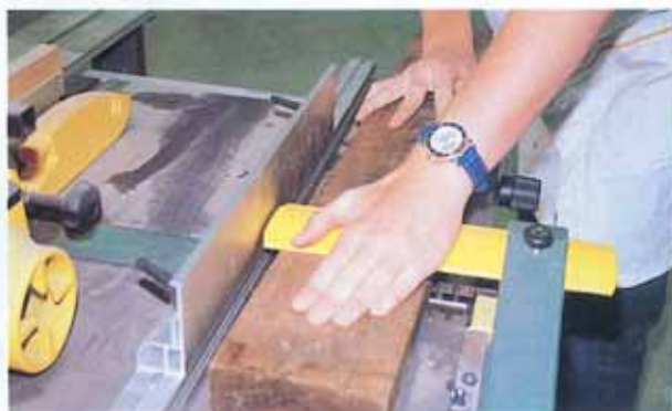
Dégauchissage à plat sous le protecteur.
