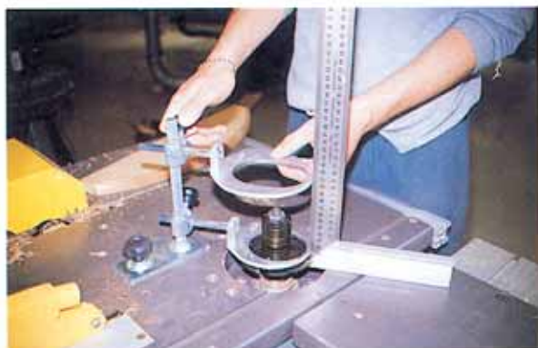
Montage du guide à lunette. Le chariot de la scie circulaire est utilisé, comme prolongateur de la table de toupie.
