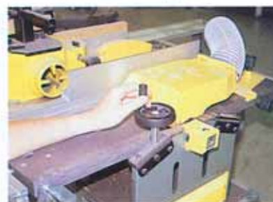
La manette de réglage de la hauteur de la raboteuse, un tour pour 3 mm.
