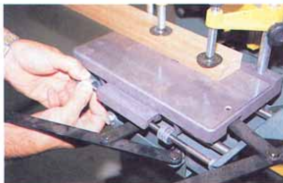
Réglage latéral de la longueur de la mortaise. Ce sont des butées qui déterminent la longueur de la mortaise.
