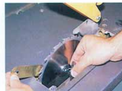
Le montage de la lame est très simple.
