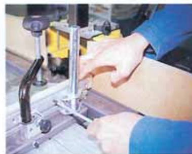
La règle pare-éclat sur le guide pour un tenonnage à fil travers.
