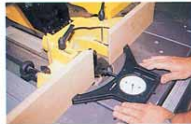
Réglage de l'outil en profondeur.
