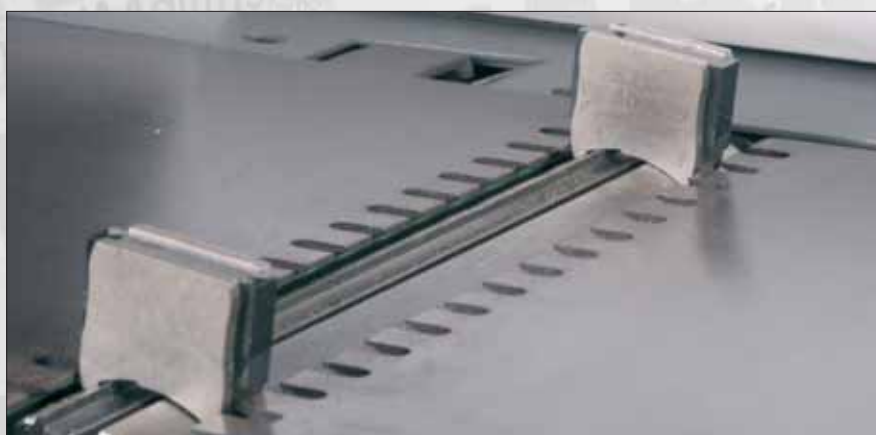
Vue n° 4: les positionneurs de fers magnétiques pour Bestcombi
