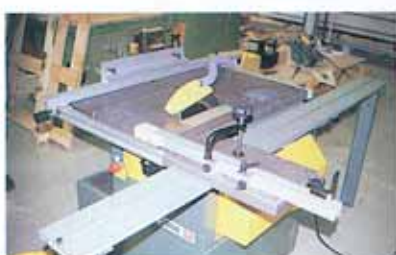
Chariot pour la scie circulaire avec grand rail de deux mètres en option.
