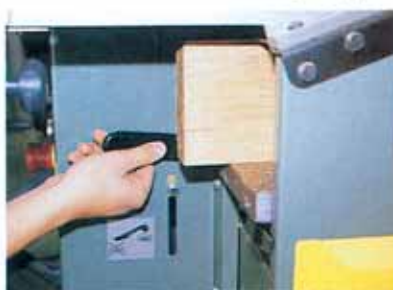
En cas d'anomalie, l'entraînement est débrayé. Ici, la manette de débrayage.
