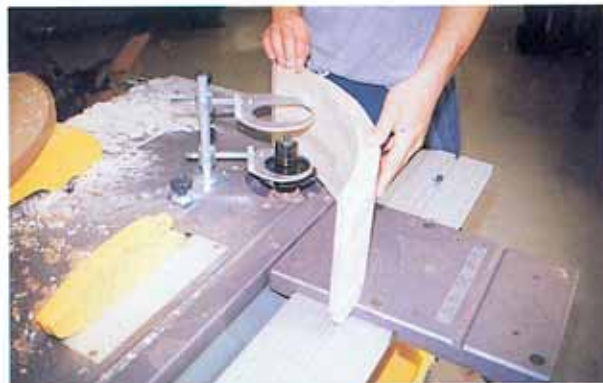
le guide à lunette utilisé dans la réalisation de rainure en façade de tiroirs de commode demi-lune.
