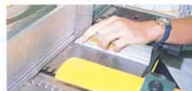
Vérification de l'équerrage du guide.
