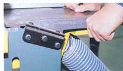
Hauteur de la table réglable de 0 à 5 mm.
