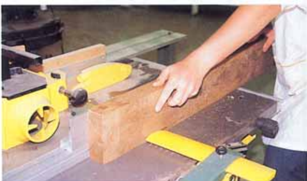
Dégauchissage sur chant, derrière le protecteur.
