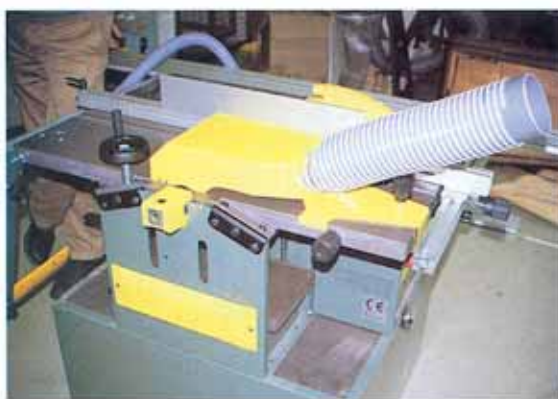
Le capteur mis en place. Il participe activement à la sécurité en masquant les fers.
