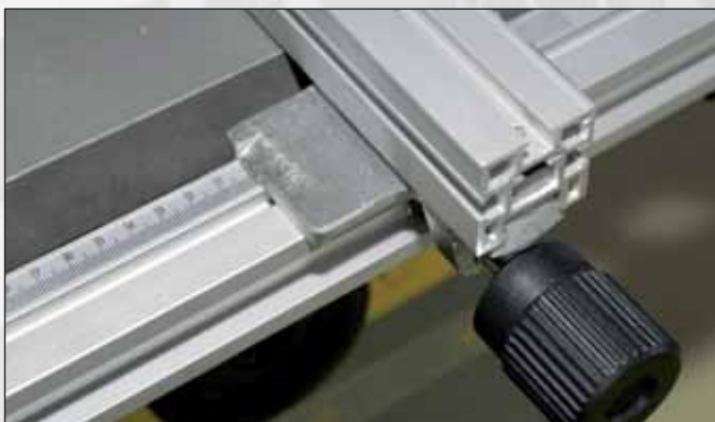
Vue n° 18 : L'index de lecture est réglé sur le «zéro» de la règle graduée.
