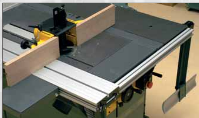
Vue n° 24 : Le guide est placé perpendiculairement au chariot coulissant.
