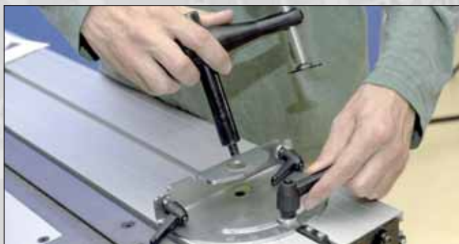
Vue n° 19 : Mise en place du guide angulaire dans la rainure du chariot coulissant.
