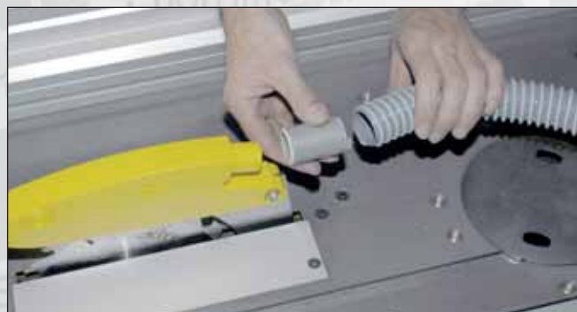
Vue n° 16 : Branchement du tuyau d'aspiration sur le capot protecteur de la lame.
