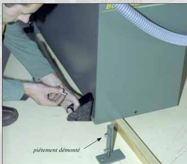
Vue n° 12 : Fixation des supports de roues.
