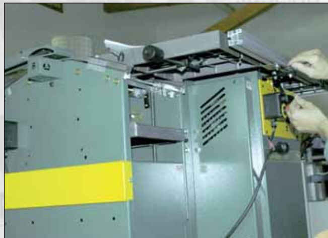
Vue n° 6 : Démontage des 2 rails latéraux.
