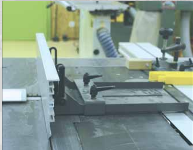
Vue n° 28 : Mise en place du guide de dégauchisseuse.
