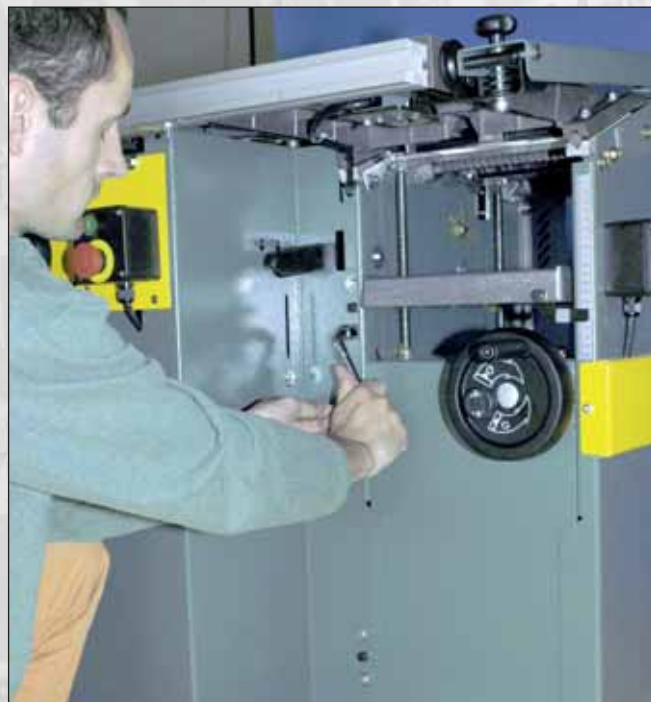
Vue n° 7 : Démontage des vis d'assemblage.
