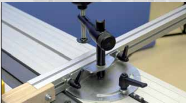
Vue n° 20 : Le guide d'appui fixé au guide angulaire.
