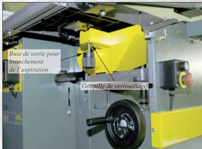
Vue n° 26 : Mise en place du capot collecteur de copeaux lors de l'utilisation de la dégauchisseuse.
