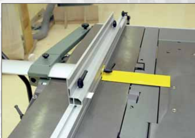
Vue n° 27 : Mise en place du capot protecteur de l'arbre de dégauchisseuse.
