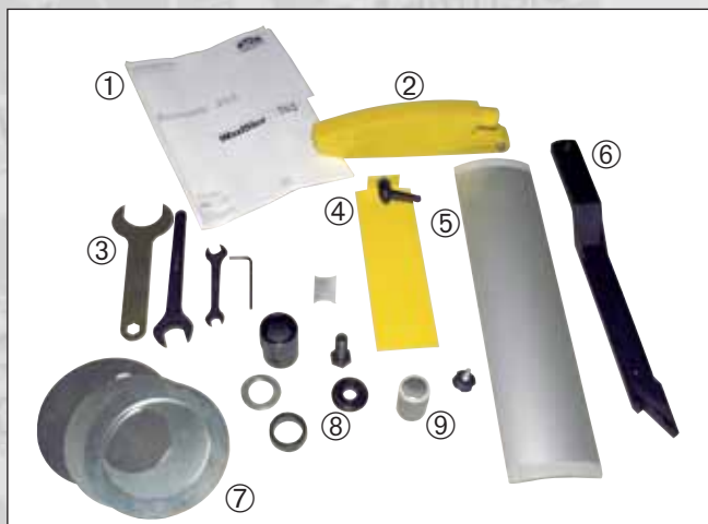
Vue n° 5 : Les accessoires et l'outillage : 1: notice du fabricant; 2: cape protectrice de la lame de scie circulaire; 3: jeu de clés plates et Allen; 4: protecteur des fers de dégauchisseuse; 5: capot protecteur de l'outil de dégauchisseuse; 6: poussoir de scie circulaire; 7: rondelles de table; 8: bagues de calage pour arbre de toupie et vis de serrage; 9: manchon pour raccord du tube d'aspiration sur cape protectrice de lame de scie circulaire.
