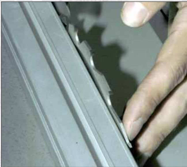
Vue n° 17 : Le guide de délignage est amené en appui contre la lame.
