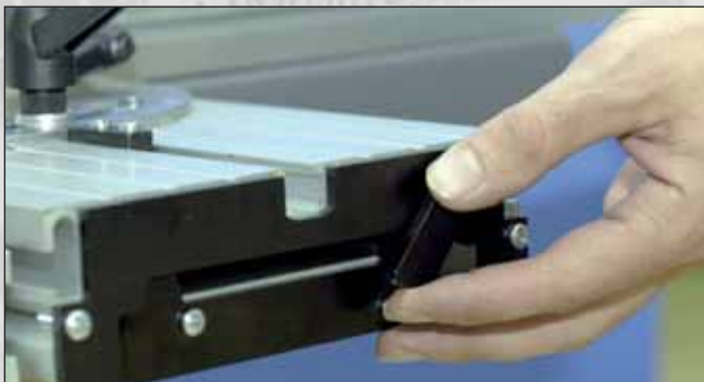
Vue n° 22 : Immobilisation du chariot coulissant grâce aux loquets de verrouillage de ses extrémités.
