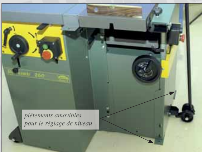
Vue n° 14 : Mise à niveau de la machine.
