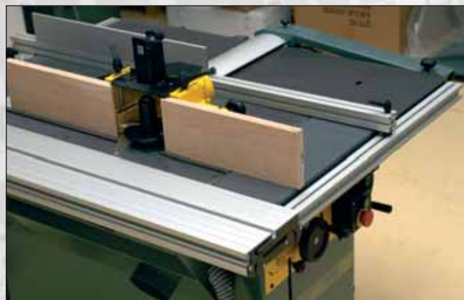
Vue n° 23 : le guide est placé parallèlement au chariot coulissant.
