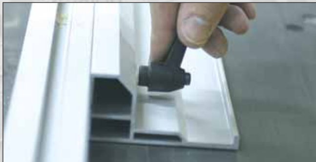
Vue n° 18 ter : Rehausseur du guide de délignage fixé latéralement par rapport au guide initial.
