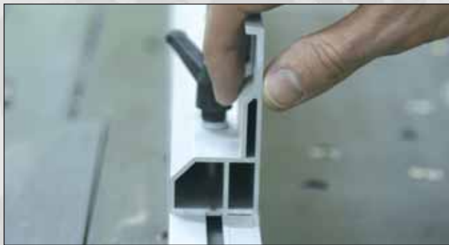
Vue n° 18 bis : Rehausseur du guide de délignage fixé au-dessus de guide initial.
