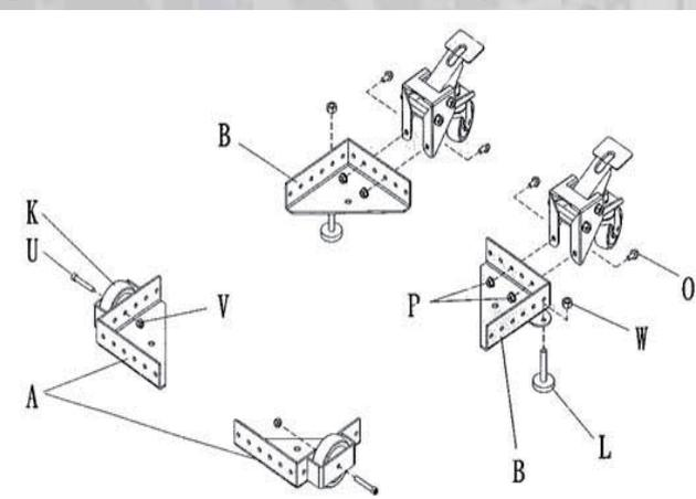
**Étape 2:** montez les angles pour roues fixes comme sur le dessin. Vissez provisoirement les écrous qui pourront être repositionnés lors de la fixation des profilés.
