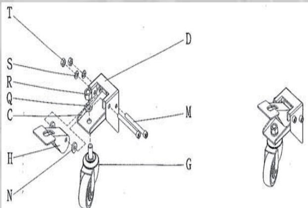
**Étape 1:** assemblez les deux supports de roue 360° comme sur le dessin. Installez les rondelles caoutchouc de chaque côté du levier d'escamotage. **SERREZ LES VIS «M» SEULEMENT A LA MAIN** pour ne pas déformer le pivot «D» avant son montage sur les angles.
