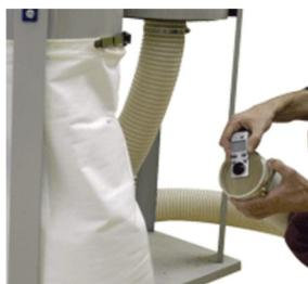
**Test n°1** - Mesure en mètre/seconde (à l'aide d'un anémomètre électronique) de la vitesse de l'air entrant dans l'aspirateur, puis calcul des débits à vide, avec un tuyau d'aspiration standard (diamètre 100 mm, longueur 2 mètres). Ce test permet d'évaluer, pour chaque appareil, la perte de charge due au tuyau d'aspiration.
