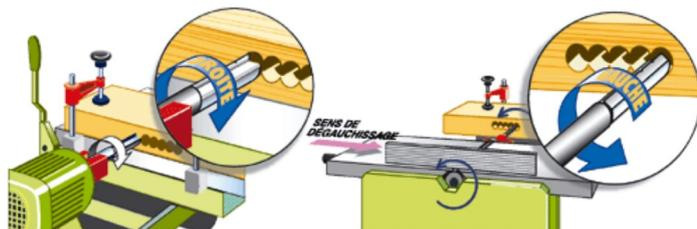
**BON À SAVOIR** : les [mèches à mortaiser](#) existent en **rotation à gauche** et **rotation à droite**. 90 % des machines tournent à gauche, c'est-à-dire dans le sens inverse d'une perceuse. C'est en particulier le cas de toutes les mortaiseuses en bout d'arbre de dégauchisseuse. Un point à vérifier impérativement lors de la commande.
