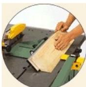
Dégauchir en angle grâce au guide de dégauchissage inclinable de 0 à 45°.
