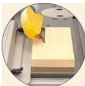
Déclignage au guide, à 90° ou en angle grâce à l'inclinaison de la lame.
