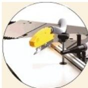
Découpe d'angle grâce au guide de sciage orientable.
