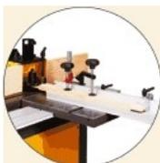
Réalisation de tenons à la toupie sur le chariot de tenonnage.
