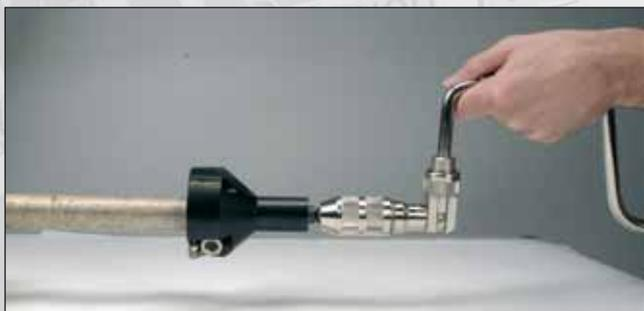
Photo 9 : pour obtenir un tenon droit : tenonnage dans l'axe du bois.
