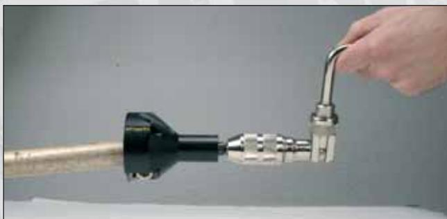
Photo 10 : tenonnage pour un assemblage incliné.
