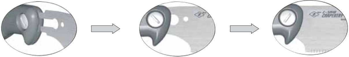
Insérez la lame dans la fente du manche comme montré ci-dessus. Lorsqu'elle est parfaitement positionnée en butée contre la vis serrez alors celle-ci à l'aide d'un tournevis ou d'une pièce de monnaie.
