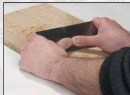
• Les index et majeurs sont placés à l'avant au niveau des coins inférieurs pour bien maîtriser l'appui sur le bois.
