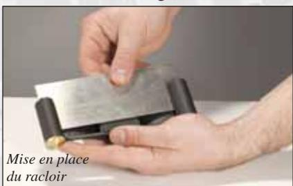
4. Glissez le racloir entre la face plane des cônes en laiton et les points d'appuis semi-circulaires du porte-racloir.
