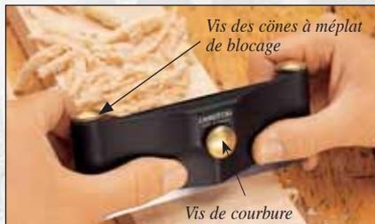
1. Desserrez la vis de réglage de courbure et les deux vis des cônes à méplat de blocage en laiton (voir photo ci-dessus).
