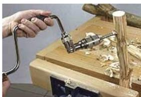
C'est très simple : d'un côté vous réalisez une mortaise (un simple trou avec la mèche fournie)...
