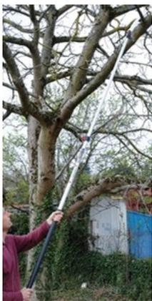
De faible poids (un kilo environ), très maniable, elle est peu contraignante à porter et à manipuler, même tenue à bouts de bras. Le profil ovalisé de la perche permet de facilement orienter la lame dans les directions nécessaires.
