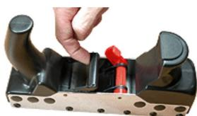
2- relever la barre d'appui du "bloc fer contre-fer"
