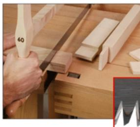
La lame japonaise, de grand rendement et conçue pour couper en tirant ou en poussant, confère à cette scie à cadre une "puissance turbo" insoupçonnée, particulièrement en coupe transversale.
