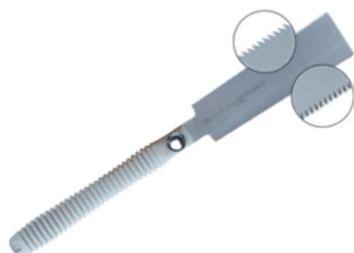
La scie japonaise traditionnelle par excellence. Un haut rendement de coupe et une conception à double denture (pour coupe à la fois en travers fil et dans le sens du fil), idéale pour les réalisations d'assemblage, de tenonnage ou autres car vous passez immédiatement d'une denture à l'autre.
