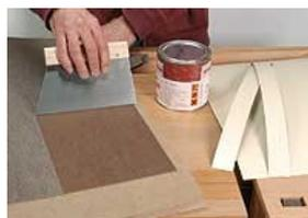
L'application de ces colles sur de grandes surfaces nécessite la rapidité de l'opération. On utilise alors une spatule dentée large pour un rendement maximum.
