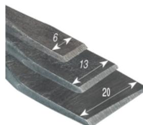
Ce sont les outils "à tout faire" : nivellement de surface, évidements, ajours, gravures, tailles ornementales, rainures, cannelures, façonnage des moulures, etc...
