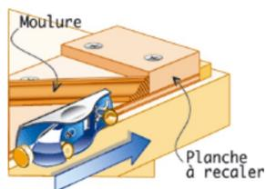
Les rabots dit "à recaler" **permettent d'ajuster à la perfection les coupes en bout ou les coupes d'onglet à la planche à recaler.**
