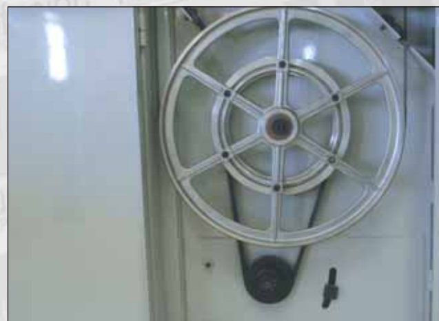
Système de tension courroie. (Changement de vitesse)
