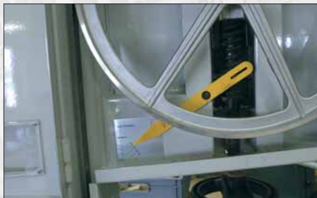
Photo du volant supérieur avec indicateur de tension de lame.
