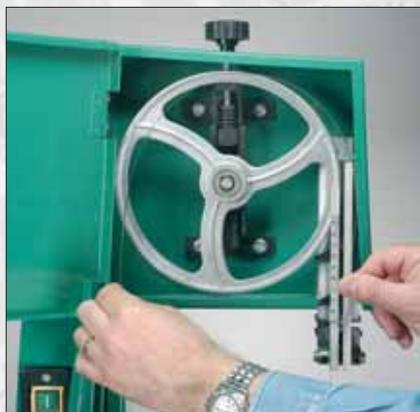
Tendez légèrement la lame en tournant manuellement le volant supérieur dans le sens des aiguilles d'une montre. Procédez maintenant à une tension définitive du ruban, adaptée à la largeur de votre lame. N'oubliez pas qu'une tension trop élevée peut occasionner la rupture précoce du ruban de scie.
