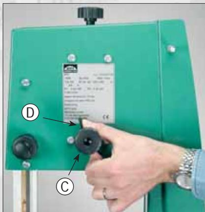
Faites tourner le volant supérieur dans le sens de coupe : si le ruban se déplace vers l'avant, tournez lentement la poignée repérée C dans le sens des aiguilles d'une montre afin de recentrer le ruban. Si le ruban se déplace vers l'arrière, tournez alors dans le
