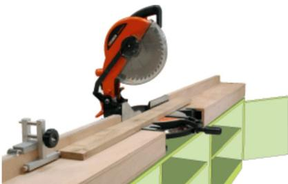
Dans le cas de la réalisation d'un poste stationnaire, on pourra installer de part et d'autre de la machine, des bancs de tronçonnage qui supporteront les pièces de bois.
