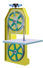
L'écartement entre les deux volants est variable, ce qui permet de donner à la lame la raideur nécessaire et l'adhérence suffisante sur les volants.
