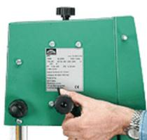
Le ruban de scie doit être presque centré sur l'épaisseur des volants. Pour ce faire, débloquez la vis papillon située à l'arrière de la scie de façon à pouvoir agir sur la poignée de réglage et faite tourner le volant supérieur dans le sens de coupe :
