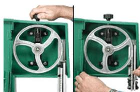
Positionnez la lame sur les volants, denture orientée correctement pour la coupe du bois.
