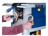
Les réglages de lame (montée-descente et inclinaison) s'effectuent par volants, avec mollette de blocage en position pour la montée-descente et indicateurs gradués pour l'inclinaison
