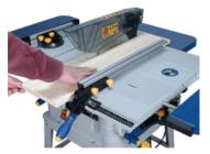
Un guide parallèle gradué réglable par poignée et de longueur égale à celle de la table de sciage (il se place à gauche ou à droite de la lame).
