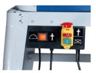
Un boîtier d'interrupteurs de sécurité permet de sélectionner la fonction scie ou défonceuse et est muni d'un bouton d'arrêt d'urgence.
