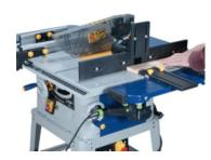
En y adaptant votre défonceuse en montage sous table, la scie circulaire devient machine à bois multifonctions! Toutes les défonceuses munies d'une semelle d'un diamètre maximum de 190 mm y sont très facilement adaptables.
