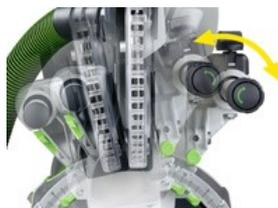
Le dispositif de réglage fin (par poignée rotative micrométrique) permet de régler l'angle de manière extrêmement précise et confortable depuis l'avant de la machine.
