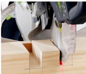
Le dispositif de limitation de profondeur de coupe, réglable en continu par levier, permet de réaliser des rainures et entailles avec rapidité et précision.
