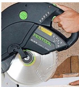
**Ergonomique** : le déverrouillage du capot et l'interrupteur se commandent aussi bien depuis la gauche que depuis la droite.
