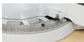
Elles permettent alors d'approcher le quart de degré ! Ces échelles sont en outre résistantes à l'usure et dotées d'une aiguille réglable.
