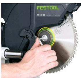
Leur remplacement (montage/démontage) s'opère de manière rapide et très pratique grâce au système de changement FastFix.
