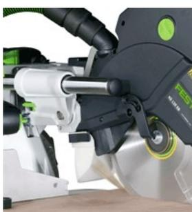
**Aspiration** : la KAPEX est équipée d'un raccord d'aspiration et d'un cône d'arrêt des copeaux très efficace : les copeaux et poussières sont aspirés dès leur apparition.
