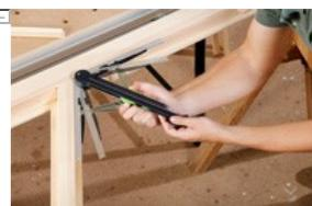
Il suffit de relever l'angle et de bloquer l'équerre en position...
