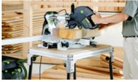
... pour une machine de cette taille ! Lors des sciages à 90°, avec les pièces posées à plat, c'est une section jusqu'à 88 x 305 mm qui peut être atteinte !
