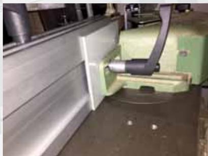
Pour remédier à ce problème, Mr Cazette a réalisé deux plaques d'appui en aluminium de 4 mm assurant un support parfait des joues du guide
