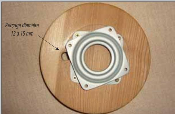
Photo 3 : perçage du socle afin de pouvoir visser le mécanisme sur l'envers du plateau.
